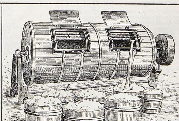
*Vue de la baratte-malaxeur, montrant le mécanisme de son mouvement, et les rouleaux dont elle est munie à sa partie inférieure.*
