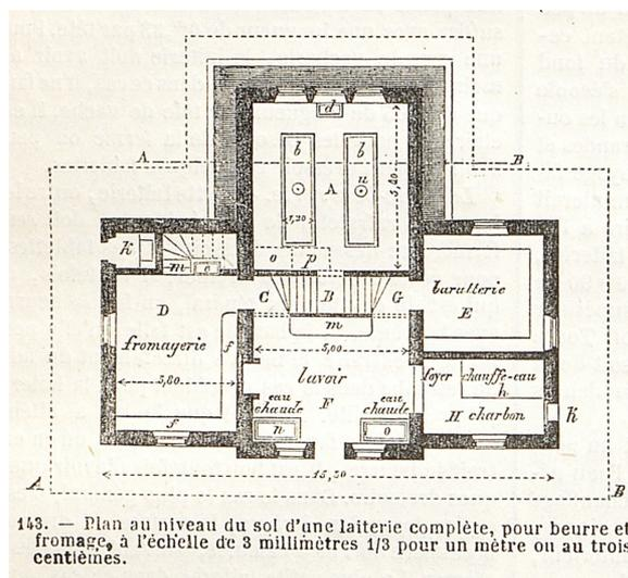
143. — Plan au niveau du sol d'une laiterie complète, pour beurre et fromage, à l'échelle de 3 millimètres 1/3 pour un mètre ou au trois centièmes.
